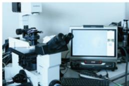
人工細胞が分裂する様子をとらえた光学顕微鏡。モニターでベシクルの様子を確認しながら動画を撮影することができる。人工細胞創製の証拠となる数々の映像を収めてきた。
